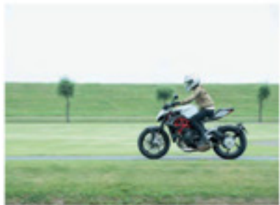
新緑の荒川土手にひとときの見える、真っ赤なトラスフレーム。こうやって見てみるとやはり重心は高い。でもその分、操縦性や運動性は抜群で、キビキビ気持ちよく初夏の風を切り裂いた。
